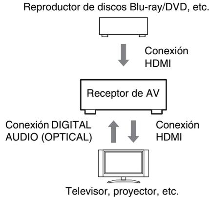
2. Conecte la salida de audio del televisor a la toma **OPTICAL IN 2** del receptor de AV usando un cable digital óptico.
