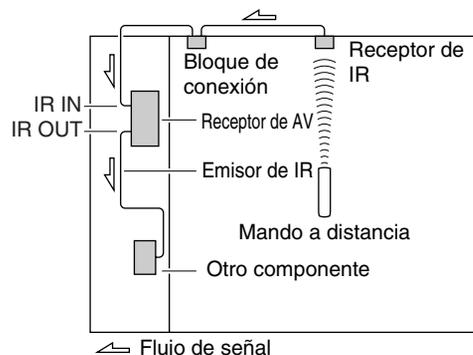
El emisor de IR debería estar conectado a la toma **IR OUT** del receptor de AV, como se muestra a continuación.
