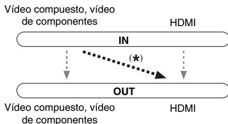
Si conecta el televisor a **COMPONENT VIDEO MONITOR OUT** (no a la salida HDMI), el ajuste “**Salida monitor**” se establece automáticamente y la fuente de vídeo compuesto se convierte de forma ascendente\* y se emite.
