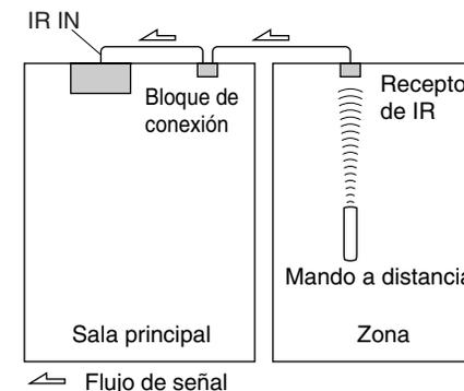
El cable de miniconector del bloque de conexión debería estar conectado a la toma **IR IN** del receptor de AV, como se muestra a continuación.
