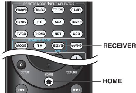
Para reinicializar el mando a distancia a sus valores de fábrica por defecto, manteniendo pulsado el botón **RECEIVER**, pulse y mantenga pulsado **HOME** hasta que se encienda **RECEIVER** (aproximadamente 3 segundos). Antes de que transcurran 30 segundos, pulse de nuevo el botón **RECEIVER**.
