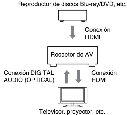
2. Conecte la salida de audio del televisor a la toma **OPTICAL IN 2** del receptor de AV usando un cable digital óptico.
