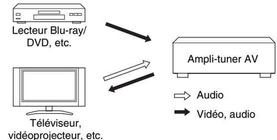
Les appareils vidéo peuvent être raccordés à l'aide de l'un des formats de connexion vidéo suivants : vidéo composite, PC IN (RVB analogique), vidéo composante ou HDMI, ce dernier offrant la meilleure qualité d'image.
