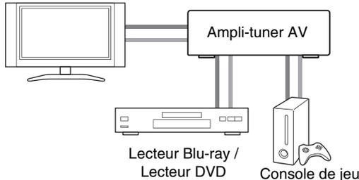
\*1 Si votre TV ne prend pas en charge le canal de retour audio (ARC - Audio Return Channel), vous devez connecter un câble numérique optique ainsi qu'un câble HDMI sur l'ampli-tuner AV.
