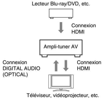
2. Branchez la sortie audio du téléviseur sur la prise **OPTICAL IN 2** de l'ampli-tuner AV à l'aide d'un câble optique numérique.
