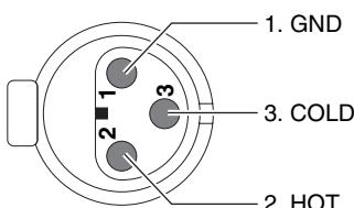
Terminal de tierra del conector: Chasis conectado a tierra
