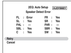
Le type d'enceinte détecté ne correspond pas à ce qui était attendu. L'enceinte est peut-être d'un type incorrect ou elle est cassée. Vérifiez qu'il s'agit bien d'une enceinte de type approprié et que tous les pilotes fonctionnent.
