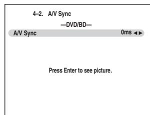
Si la fonction HDMI Lip Sync est activée (cf. page 82) et si votre téléviseur ou votre écran prend en charge la fonction HDMI Lip Sync, la durée du délai affiché correspondra à la durée du délai de synchronisation A/V. La durée du délai de la fonction HDMI Lip Sync s'affiche dessous entre parenthèses.
