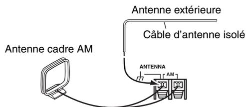
Les antennes AM extérieures fonctionnent mieux lorsqu'elles sont installées horizontalement à l'extérieur. Mais, de bons résultats peuvent parfois être obtenus en installant l'antenne à l'intérieur en la montant horizontalement au-dessus d'une fenêtre. Remarque: l'antenne cadre AM doit toujours être branchée. L'antenne extérieure doit être reliée à la terre, conformément à la réglementation locale en vigueur, afin d'éviter tout risque d'électrocution.
