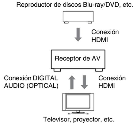
2. Conecte la salida de audio del televisor a la toma **OPTICAL IN** del receptor de AV usando un cable digital óptico.
